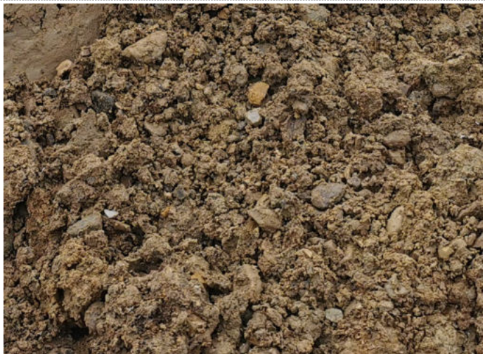
Abbildung 3 SCH01/24 Sande mit Kiesanteil ohne ausgeprägte hydromorphologische Merkmale 3,4 - 3,6 m
